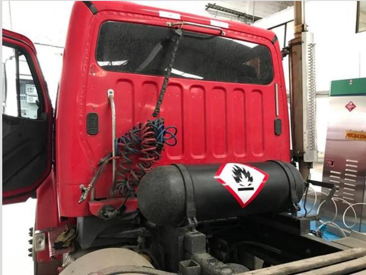
Se dualizó un camión de 26 ton diesel con una mezcla de 5% de Hidrogeno y 95% Diesel
