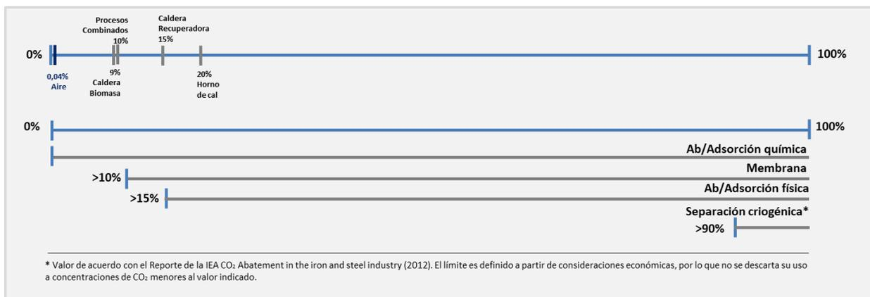
**Figura 26: Concentraciones promedio de CO<sub>2</sub> en efluentes de gases en la industria de la celulosa comparadas con las concentraciones mínimas consideradas para distintas alternativas tecnológicas. Fuente: elaboración propia a partir de [12], [22], [15], [45].**
