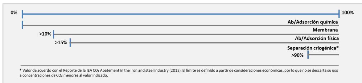
**Figura 6: Tecnologías de captura según concentraciones de CO<sub>2</sub> en la mezcla de gases de entrada. Fuente: Elaboración propia a partir de [12], [22].**
